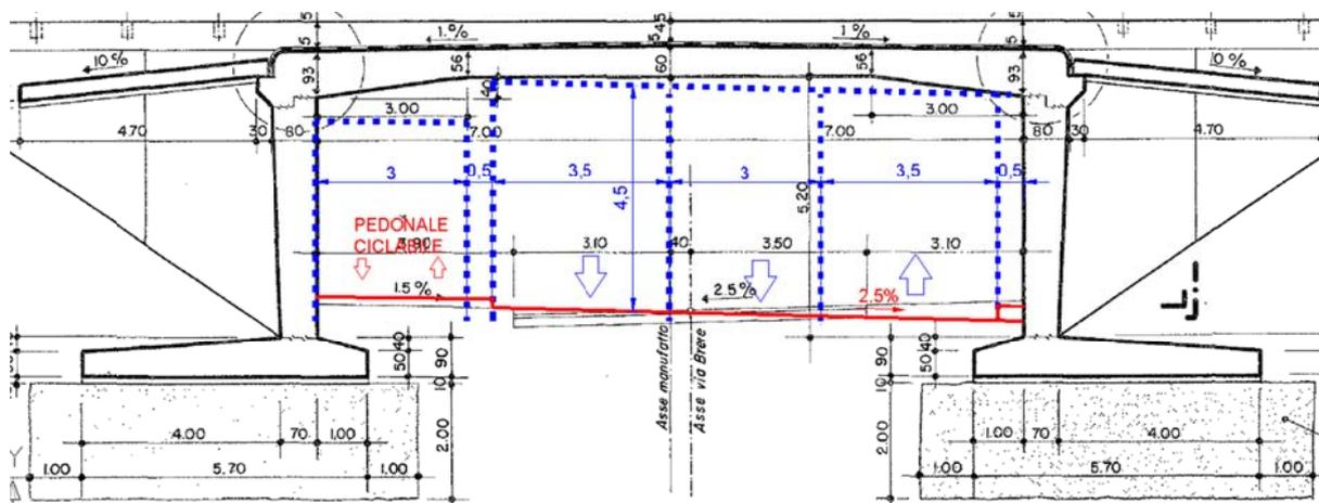
Figura 10: Sezione trasversale sottopasso di via Brere – Variante 4b
